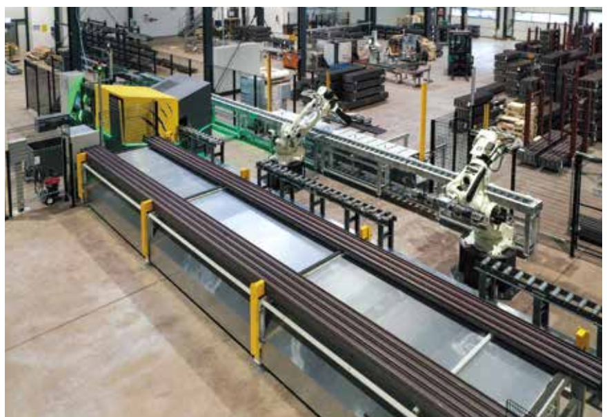
Trotz des langen Ausgangsmaterials ist die Produktionslinie kompakt gestaltet. Die beiden Roboter bedienen aus derselben Position sowohl die Einlauf- als auch die Auslaufseiten.
