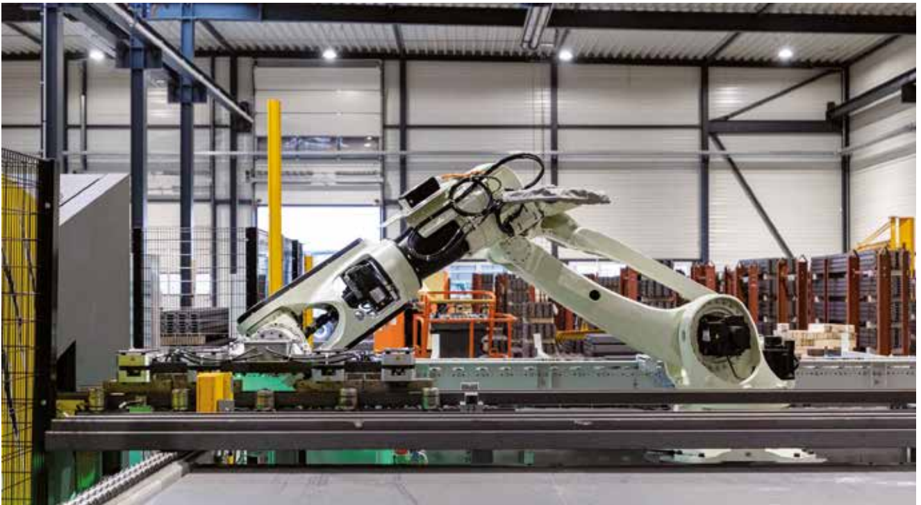
Die Eingabe der Stangen in den Säge-Automat erfolgt durch einen Roboter, während der andere die fertig gesägten Stangen an der Auslaufseite aufpalettiert.
