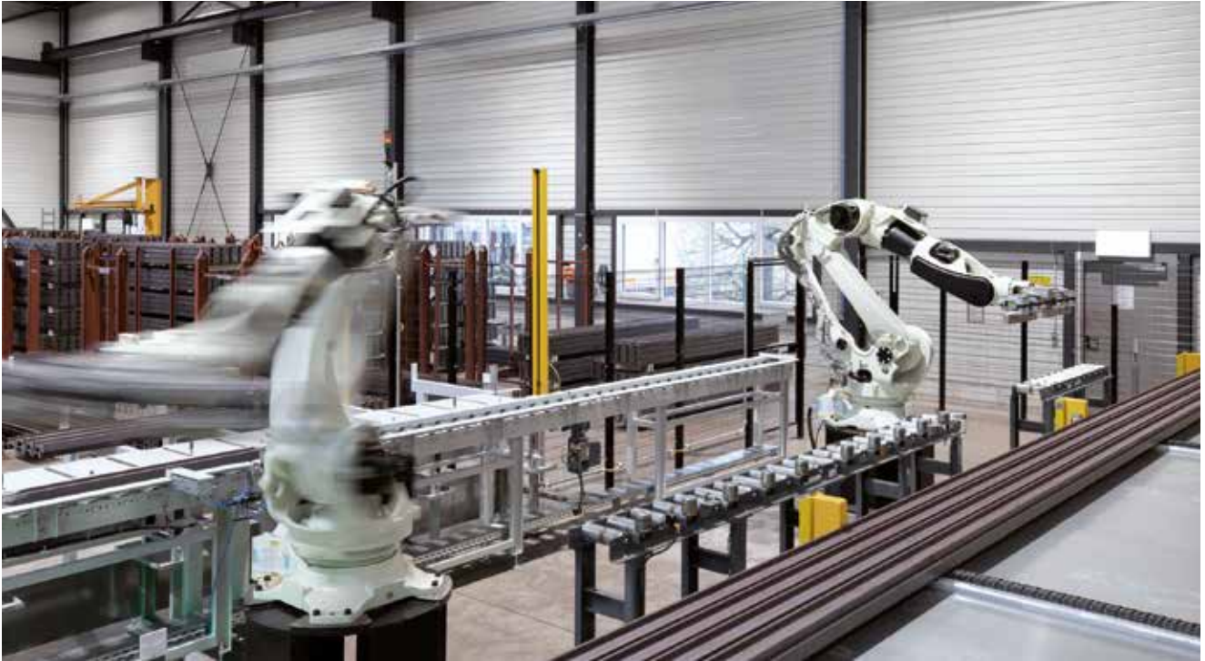
Zwei flexible 6-Achsroboter übernehmen das Abpalettieren und Beladen der Anlage mit bis zu zwölf Meter langen Profilen.
