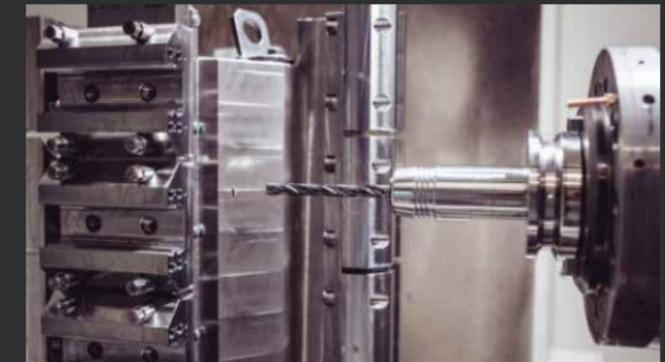
Als Bestandteil der CNC-Bearbeitung oder eigenständige Maßnahme wird das Bohren zur Erzeugung von üblichen Befestigungsbohrungen, wie im Fall einer Aufzugsführungsschiene, oder für lange Rücklaufkanäle sowie Gewindebohrungen der Linearführungs-komponenten eingesetzt.
