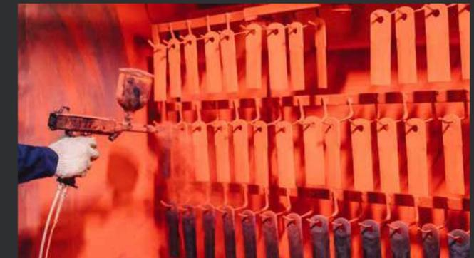
Die Pulverbeschichtung dient zum einem der äußeren Ästhetik der Produkte und zum anderen als Korrosionsschutz. Zur Beschichtung werden spezielle Trockenlacke verwendet, die auf den metallischen Oberflächen eine dünne gleichmäßige Schicht bilden.
