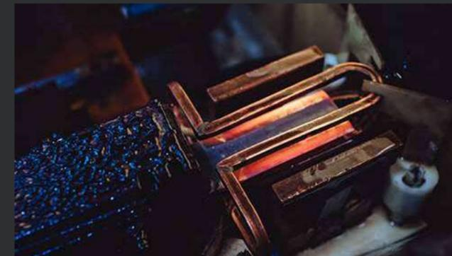
Produkte, bei denen eine hohe Verschleißfestigkeit gefragt ist, wie z.B. Messer oder Linearführungen, werden gehärtet. Dafür werden sie lokal auf eine Temperatur von ca. 1000°C induktiv erhitzt und anschließend in einer Polymerlösung abgeschreckt. Durch diesen Vorgang erhält das Material eine besonders hohe Härte.
