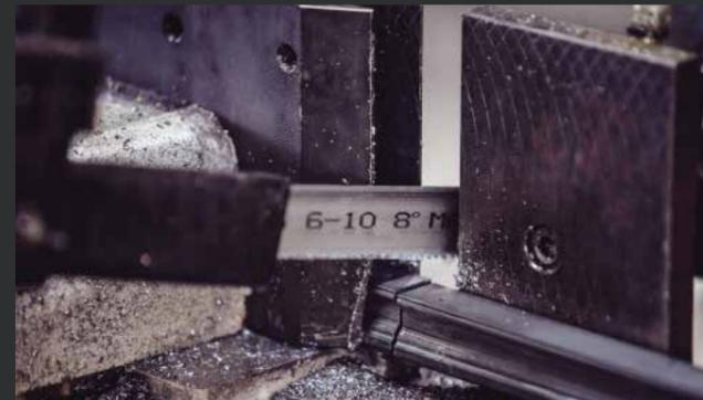
Durch das Sägen werden gewalzte Profile in Standard- oder kundenspezifische Längen geteilt. Zum Einsatz kommen Hochgeschwindigkeits- bzw. -Kreissägen. Diese laufen zum Teil im voll automatischen Betrieb.
